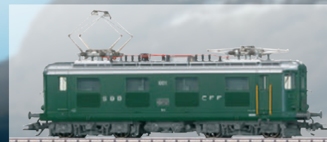
Die linke Lokseite mit den markanten Lüftergittern unterhalb der Gangfenster
