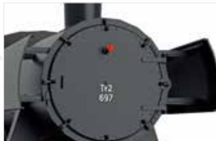
Rauchkammertüre in flacher Ausführung
