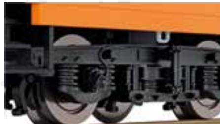
Vorbildgerechte Drehgestelle der Bauart Görlitz V modifiziert
