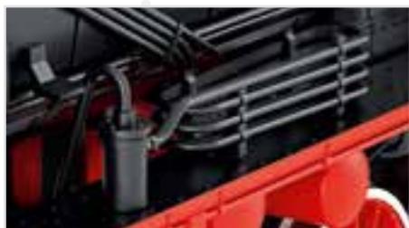
Aufwendig nachgebildeter Lufttrockner mit Ölabscheider
