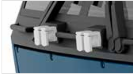
Filigrane extra angesetzte Griffstangen, UIC-Dosen und Scheibenwischer
