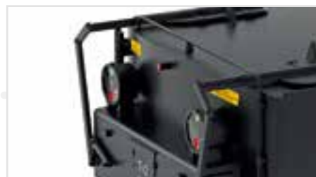
Wasserkasten-Hebel freistehend und separat ausgeführt
