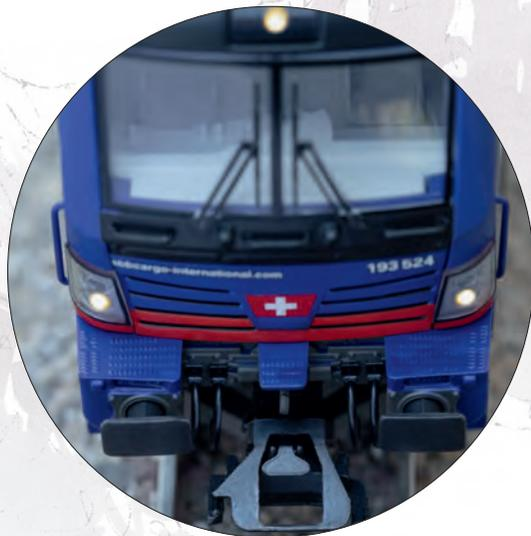
Sehr schön zeigt sich der Detaillierungsgrad. Die Kupplungen sind zurückgesetzt und Aufstiegsstangen, wie die Haltegriffe an der Front sind aus Metall und angesetzt.
