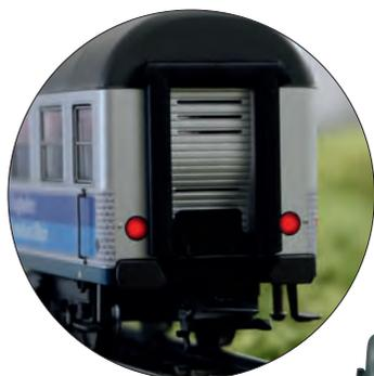
Ein Wagen mit eingebauter Zugschlussbeleuchtung
