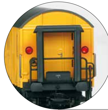
Rote Schlusslichter auf beiden Seiten jeweils digital schaltbar
