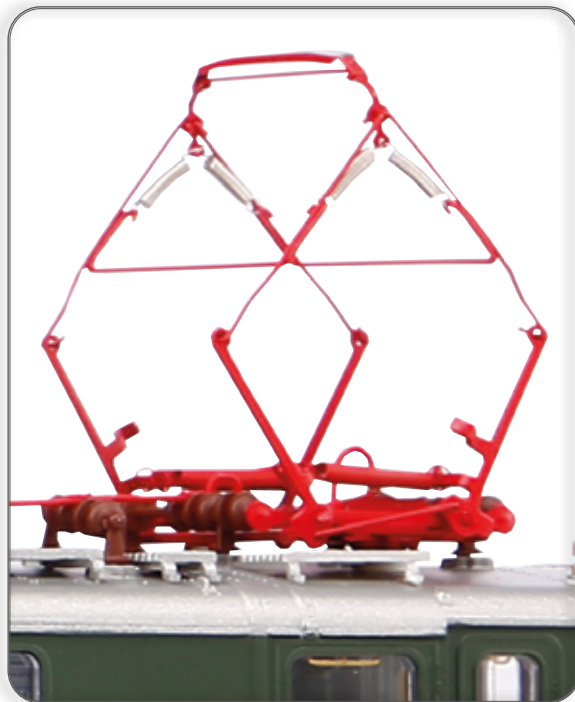
Der Scherenstromabnehmer der BR E 32 ist ein eindrucksvolles Beispiel für den feingliedrigen und filigranen Aufbau der PIKO Stromabnehmer.
