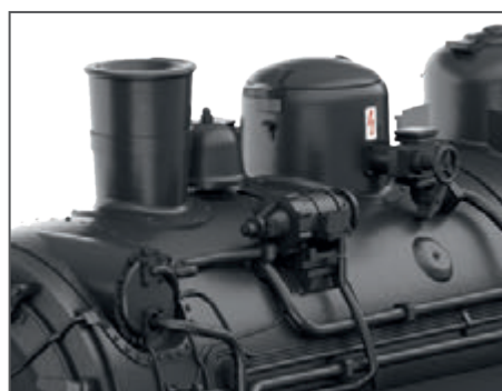
Turbo-Dynamo für elektrische Beleuchtung und Läutewerk zwischen Schornstein und Speisedom
