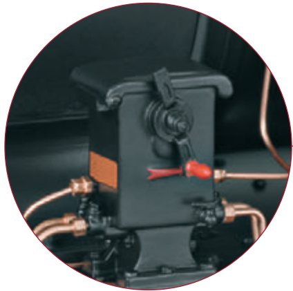
Feindetailliert zeigt sich die Schmierpumpe mit angesetzten Leitungen aus Kupfer und einem Stellhebel mit rot abgesetztem Griff
