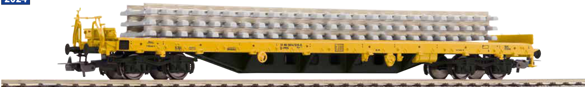
24501 Flachwagen Rs Bauzug Ep. VI, beladen mit Betonschwellenstapel
