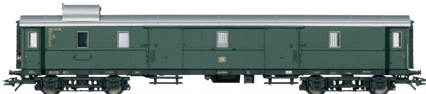
Gepäckwagen mit eingebauter Zugschlussbeleuchtung und Radschleifer zur Stromversorgung
