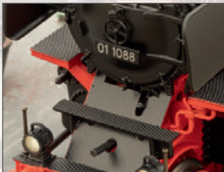
Eines der Merkmale der Aufarbeitung im PAW Henschel: Das Löscheschutzblech reicht nicht bis zum Kessel.
