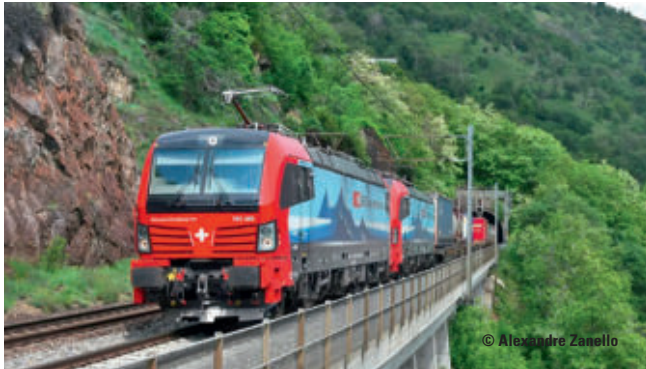
Vorbild: Mehrsystem-Elektrolokomotive Baureihe 193 (Siemens Vectron) der SBB Cargo International im Zustand der Epoche VI um 2018.
